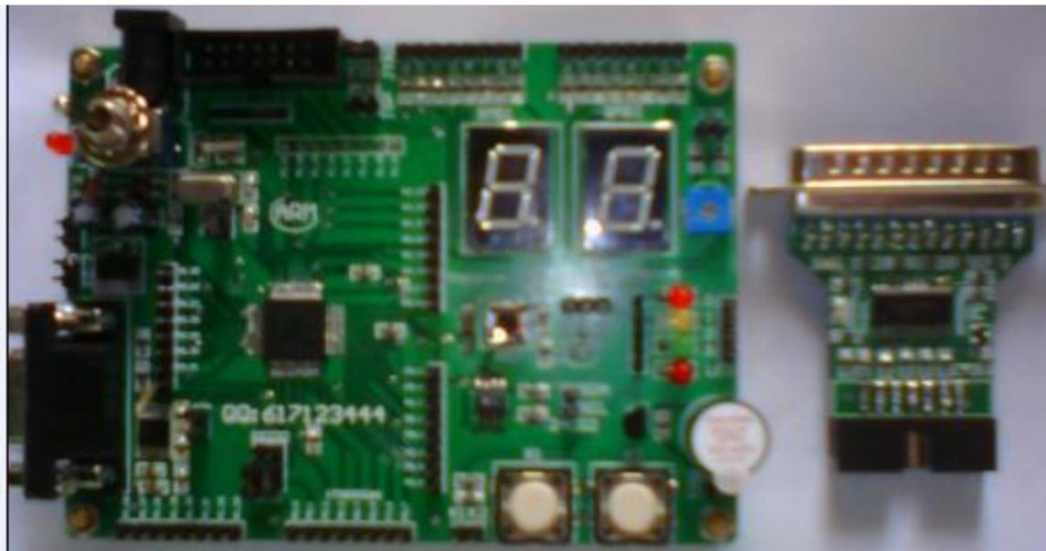
拥有两个数码管，四个 LED 灯一个，一个可变电阻，一个蜂鸣器，一个 24C02，一个串口，一个 DS18B20 扩展余地。
