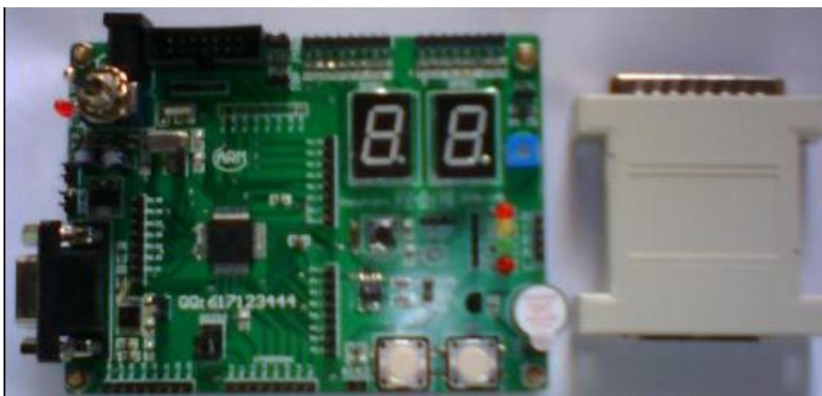
与普及型相比，增加了 DS18B20 测温元件，将 WIGGLER 下载电缆加一个外壳，方便使用。
